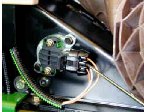
Gaspedaalsensor John Deere Witte draad is signaaldraad.
